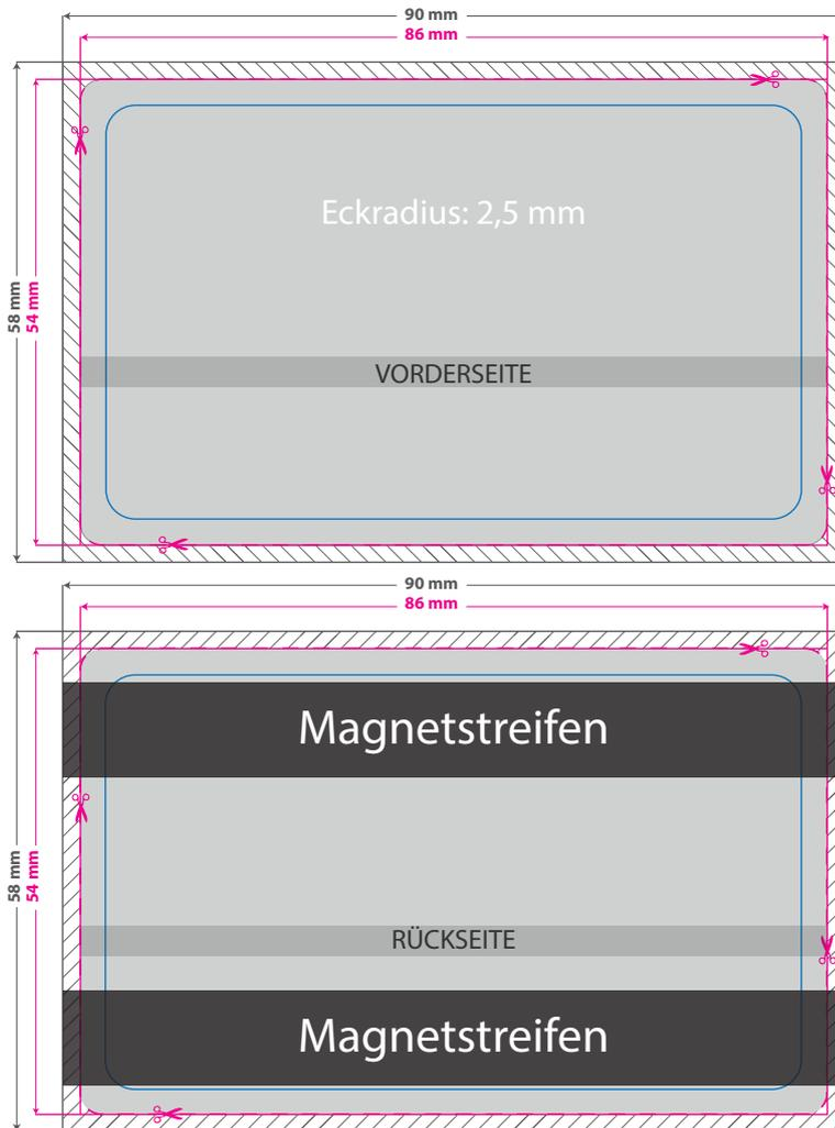
Bitte senden Sie uns die gewünschte Magnetstreifenplatzierung in einer separaten Ansichtsdatei (jpg) und wählen zwischen den beiden hier gezeigten Optionen. Entfernen Sie den Magnetstreifen bitte aus der Druckdatei und senden uns die dem Auftrag entsprechende Seitenzahl. (1/0 = eine Seite; 1/1 = zwei Seiten)
